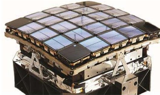
Abb. 2: Die Kepler CCD-Kamera (Quelle: [8]).
