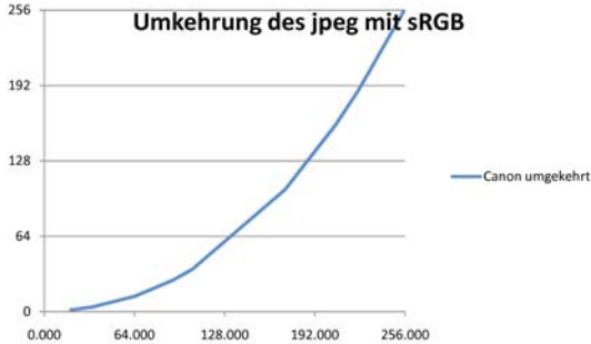
Abb. 10 Umkehrfunktion für Kamera-JPG zur Kompensation der Gammakurve
